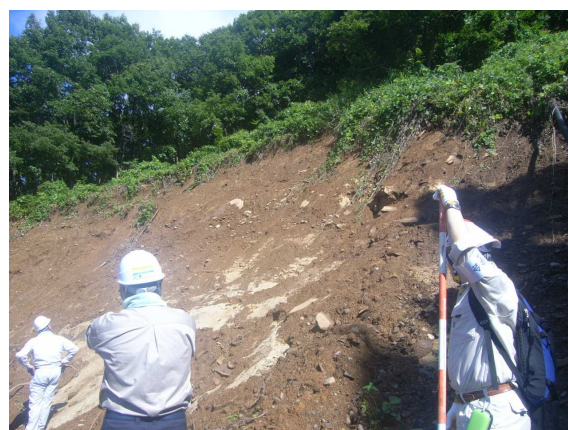
写真 5.5 滑落崖（岩盤の傾斜は約 40^{\circ} ）
