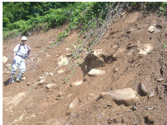
写真 5.6 滑落崖の岩盤を覆う崖錐堆積物
